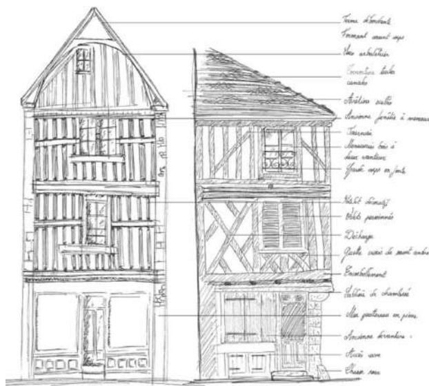
Plan d'une maison à pan de bos datant de la Renaissance
